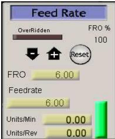
**Feedrate:** Permite ingresar un avance para movimientos de corte. Para ingresar un valor, marcar este campo con el Mouse y luego ingresar el valor deseado, luego apretar Retorno en el teclado para confirmarlo, en caso de no hacerlo el valor no quedará registrado.
