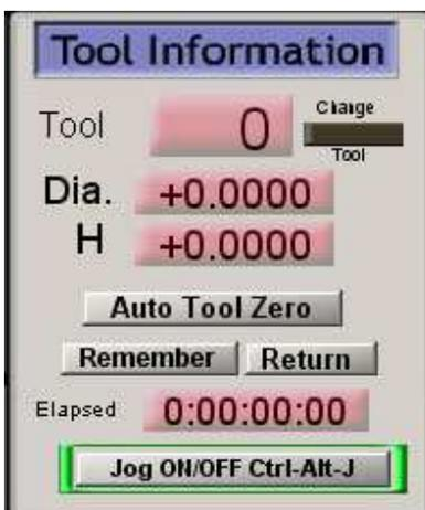
La maquina que esta usando no posee cambio automático / rápido de herramientas, es por eso que esta sección no es de gran uso, es útil en el caso de que tenga uno de los sistemas mencionados porque le permitirá hacer uso de una tabla predefinida de herramientas. La herramienta numero 0 es un valor que no se puede modificar y se usa cuando no se dispone de cambiador de herramientas.
